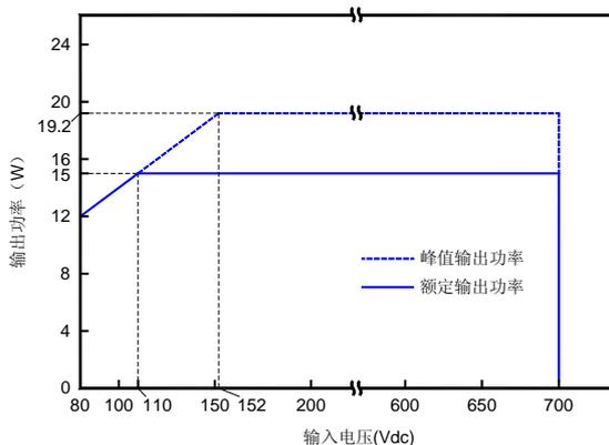
图2: 直流电压输入-输出功率降额曲线
