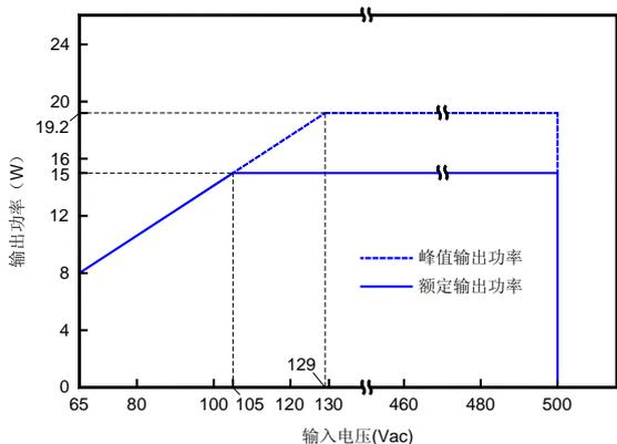
图1: 交流电压输入-输出功率降额曲线
